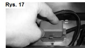
Rys. 17 Założyć i zapiąć skrzynki połączeń
